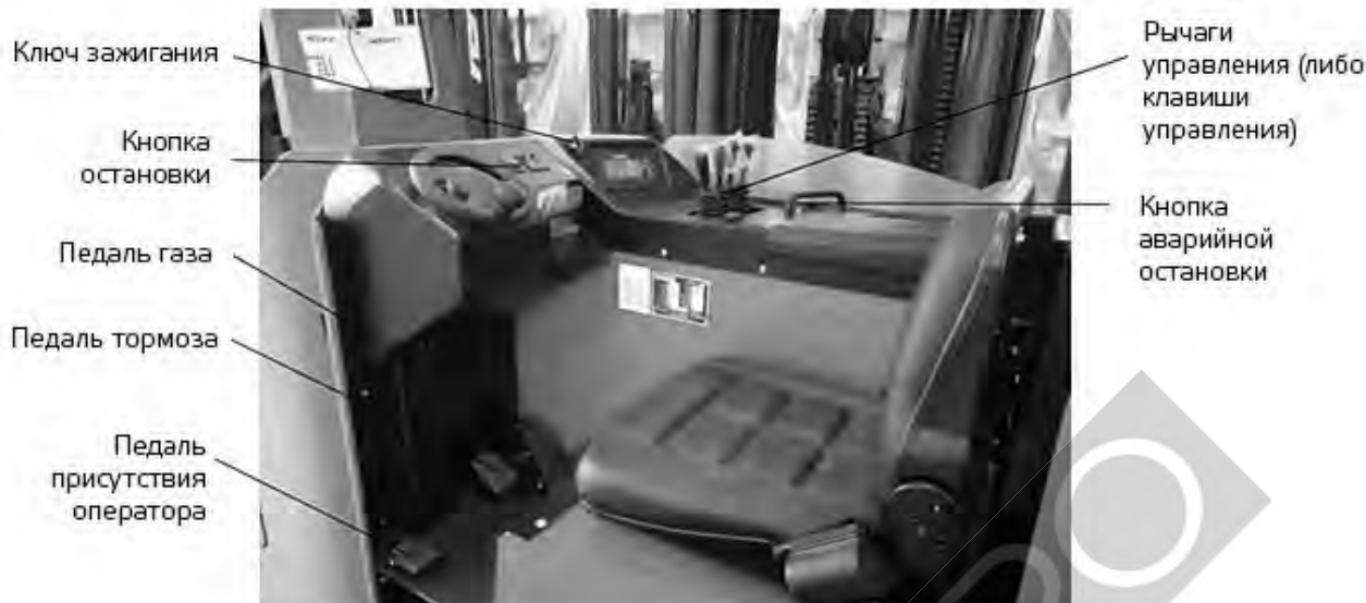
Рисунок 10. Основные устройства управления в кабине оператора
