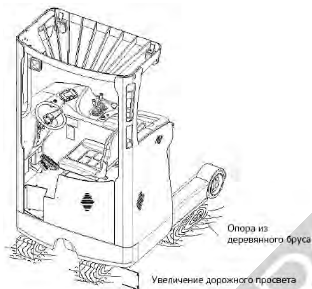
Рисунок 34. Положение ричтрака во время длительного хранения
