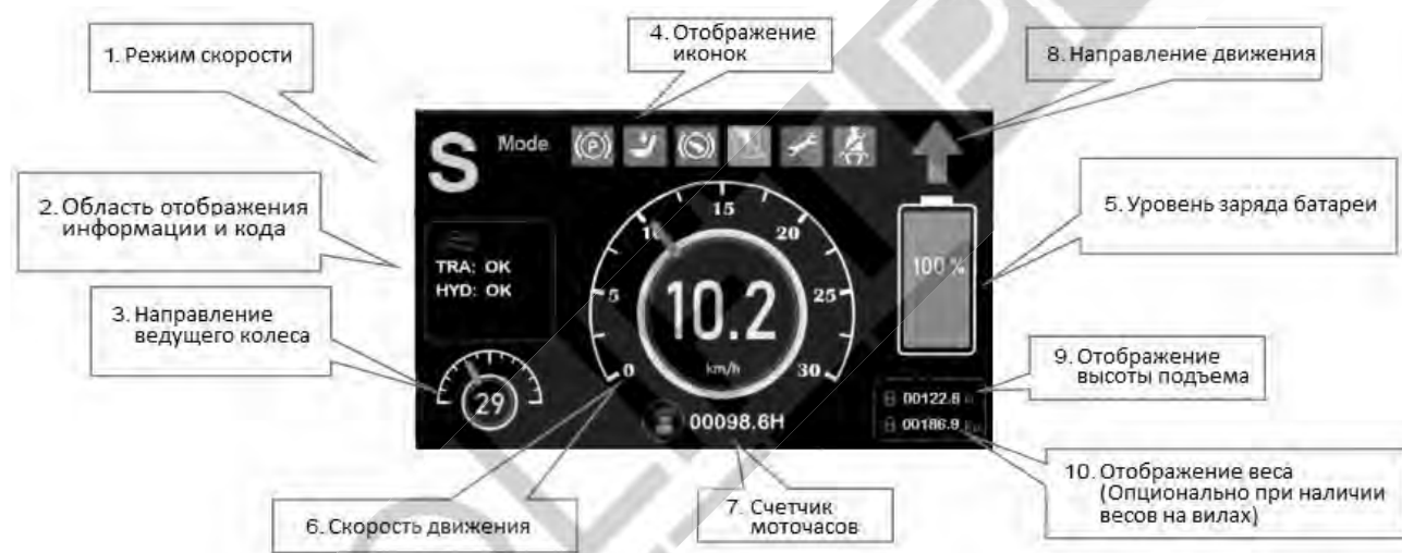
Рисунок 36. Индикатор заряда батареи на дисплее ричтрака
