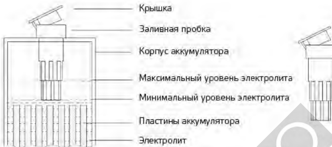
Рисунок 35. Проверка уровня электролита в аккумуляторе ричтрака
